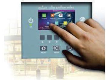
PAVA (Public Address Voice Alarm) de Honeywell, es un sistema de megafonía de amplificación y distribución electrónica de sonido que consta de micrófono, amplificador y altavoces.
